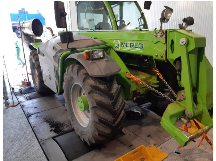
I banchi freno attivi rigenerativi Intesys utilizzano come elemento frenante un motore elettrico controllato da un inverter. Il motore+inverter trasforma l'energia meccanica del motore in prova in energia elettrica che può essere restituita alla rete elettrica tramite l'apposito Active Front End (AFE)
