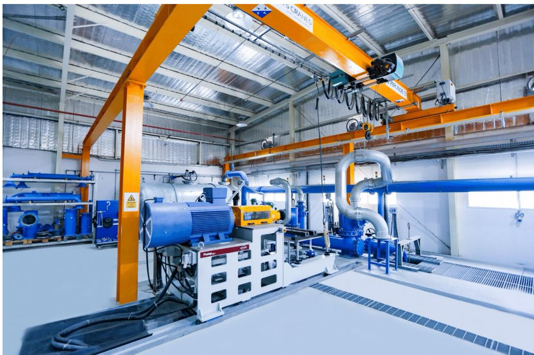
**PumpTest** è un sistema computerizzato che consente l'automazione del processo di collaudo delle pompe centrifughe per acqua e delle elettropompe per laboratorio e per linee di produzione.
